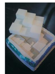
Figura 4: molde en silicona junto con la pieza impresa que reproduce.
